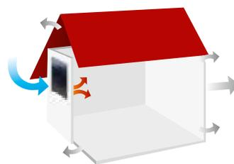
Die durch den SolarVenti® vorgewärmte Frishluft belüftet und entfeuchtet. So verbessern Sie das Raumklima und sparen Heizkosten. Durch Undichtigkeiten in der Gebäudehülle entweicht die verbrauchte Abluft.
